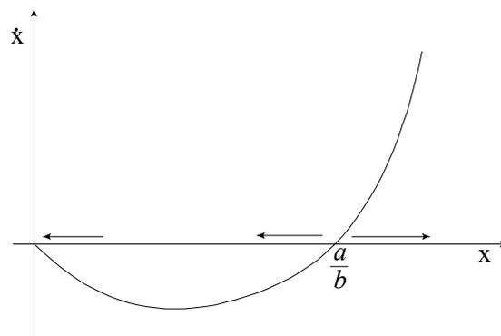
**Figura 1.10.** Diagrama de fase de la ecuación  $\dot{x} = -ax - bx^2$
