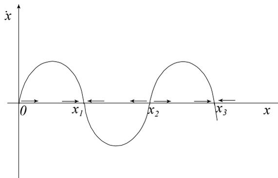
**Figura 1.13.** Diagrama de fase de  $\dot{x} = f(x)$  con diversos puntos de equilibrio
