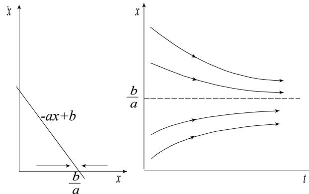
**Figura 1.12.** Diagrama de fase y trayectorias temporales de  $\dot{x} + ax = b$
