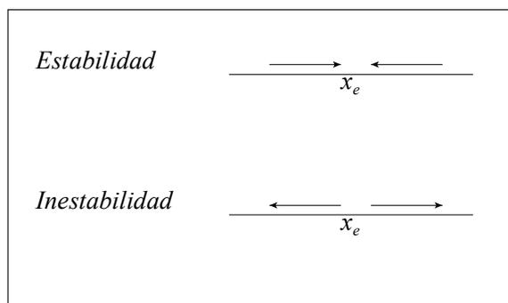
**Figura 1.8.** Representación de la estabilidad e inestabilidad de  $x_e$
