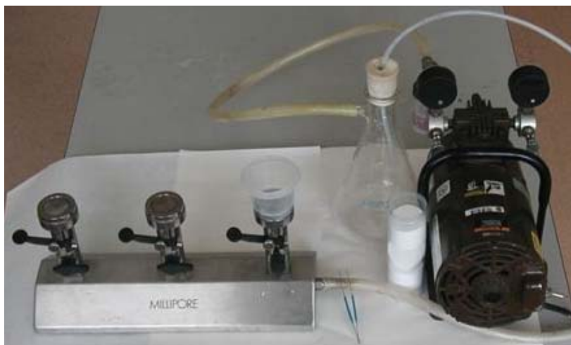
Foto 4.1. Aspecto del equipo para medir SS en agua.
