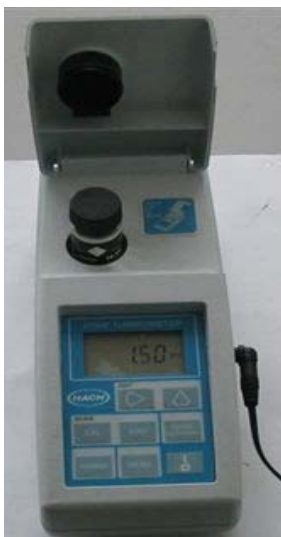
Foto 5.1. Turbidímetro portátil modelo HACH 2100P Portable.
