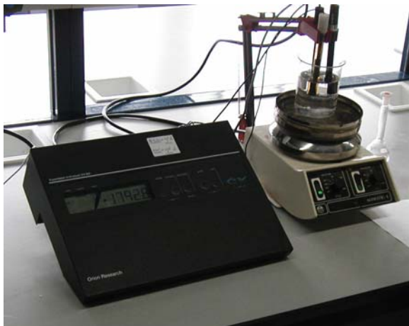
Foto 14.1. Equipo para medir iones por electrodos selectivos: ionómetro, electrodos y agitador.
