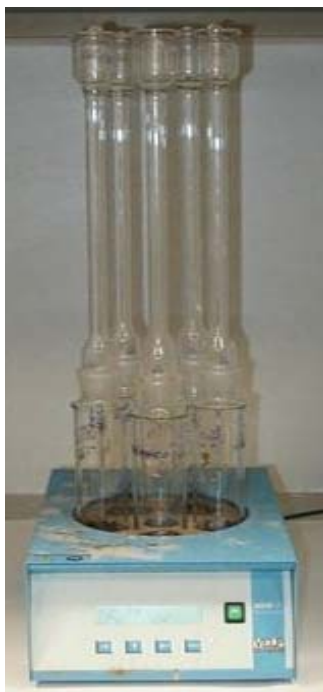
Foto 2.1. Digestor con bloque calefactor, tubos para muestras y para recogida de gases.
