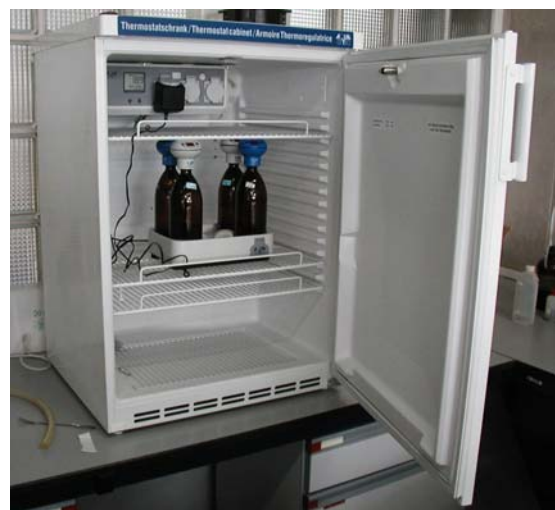
Foto 1.1. Botella con sensor de presión y disoluciones (izquierda) y cámara termostatarizada con agitador multipuestos y muestras (derecha).
