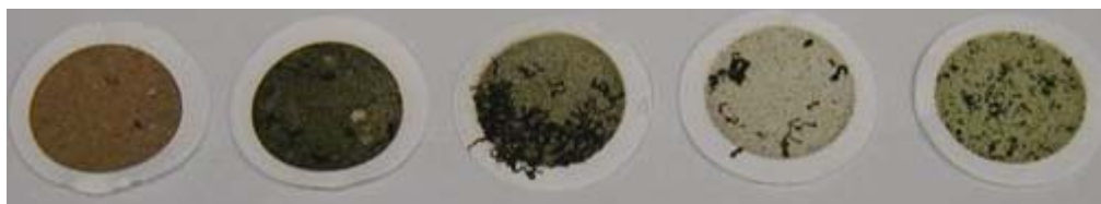
Foto 4.2. Filtros con sólidos retenidos de la depuradora natural de Tafira.
