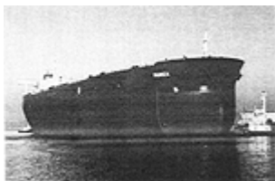
Figura 15 El Murex es el primero de la serie de cinco petroleros construidos para la compañía petrolera Shell. Cada buque posee un casco doble y transporta 2.15 millones de barriles de crudo a una velocidad de 28 kilómetros por hora. El Murex tiene 332 metros de eslora y se extiende 22 metros bajo la superficie del agua cuando está cargado completamente.
